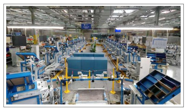
Cette chaine est en fonctionnement en 2 et 3 « huit » depuis 6 ans sans problème. Elle permet d'assembler les volets arrières des voitures Peugeot et Opel. Le principe est de placer des opérateurs à la périphérie de l'anneau avec une zone d'intervention pour chacun.
